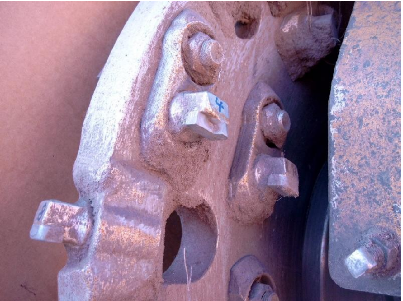
Immer wieder die Ecke der Hartmetallplatte. Platte recht weit außen.
