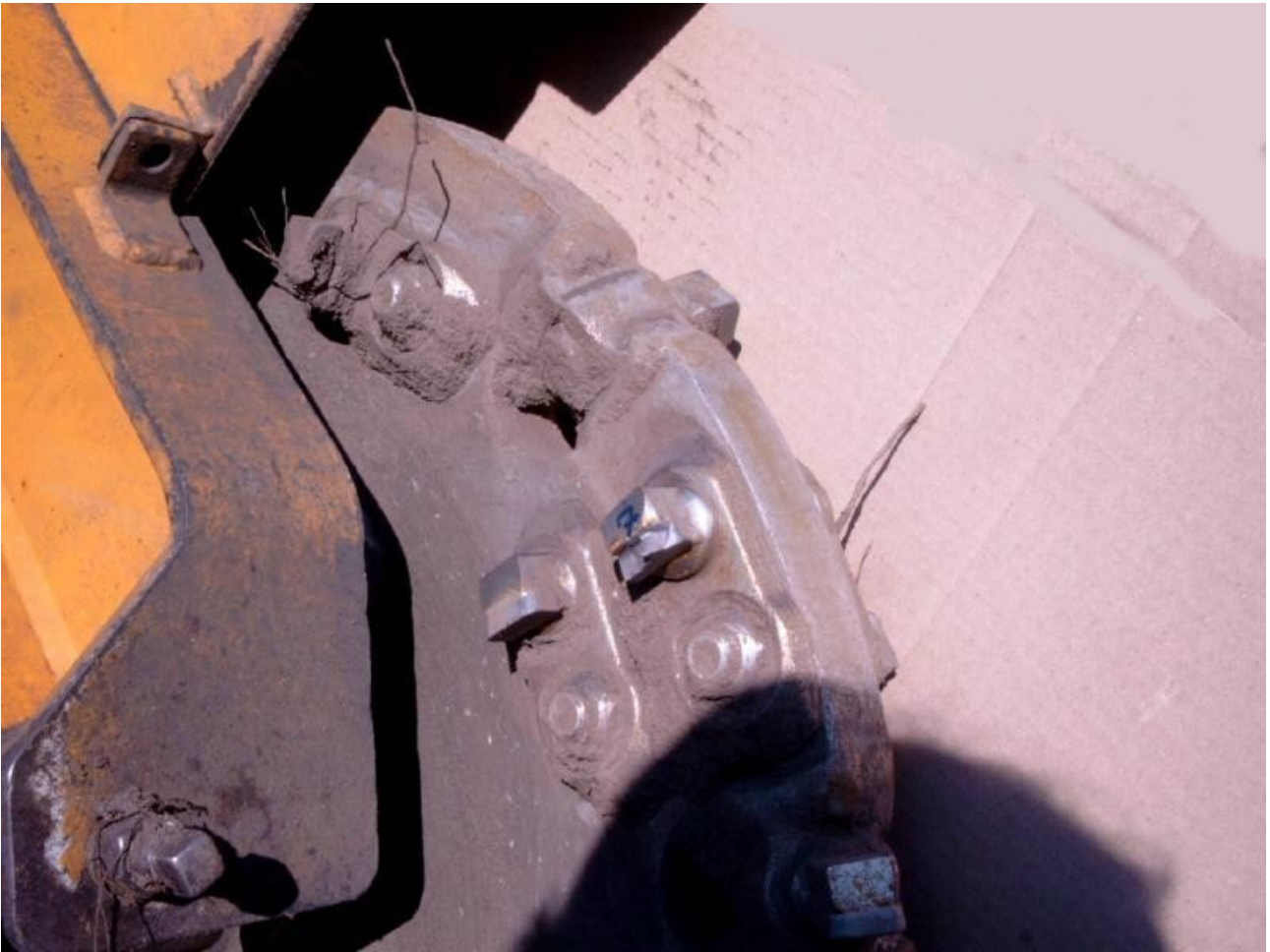
Schwerste Bruchstellen durch einwandfrei zu hartes Hartmetall.
