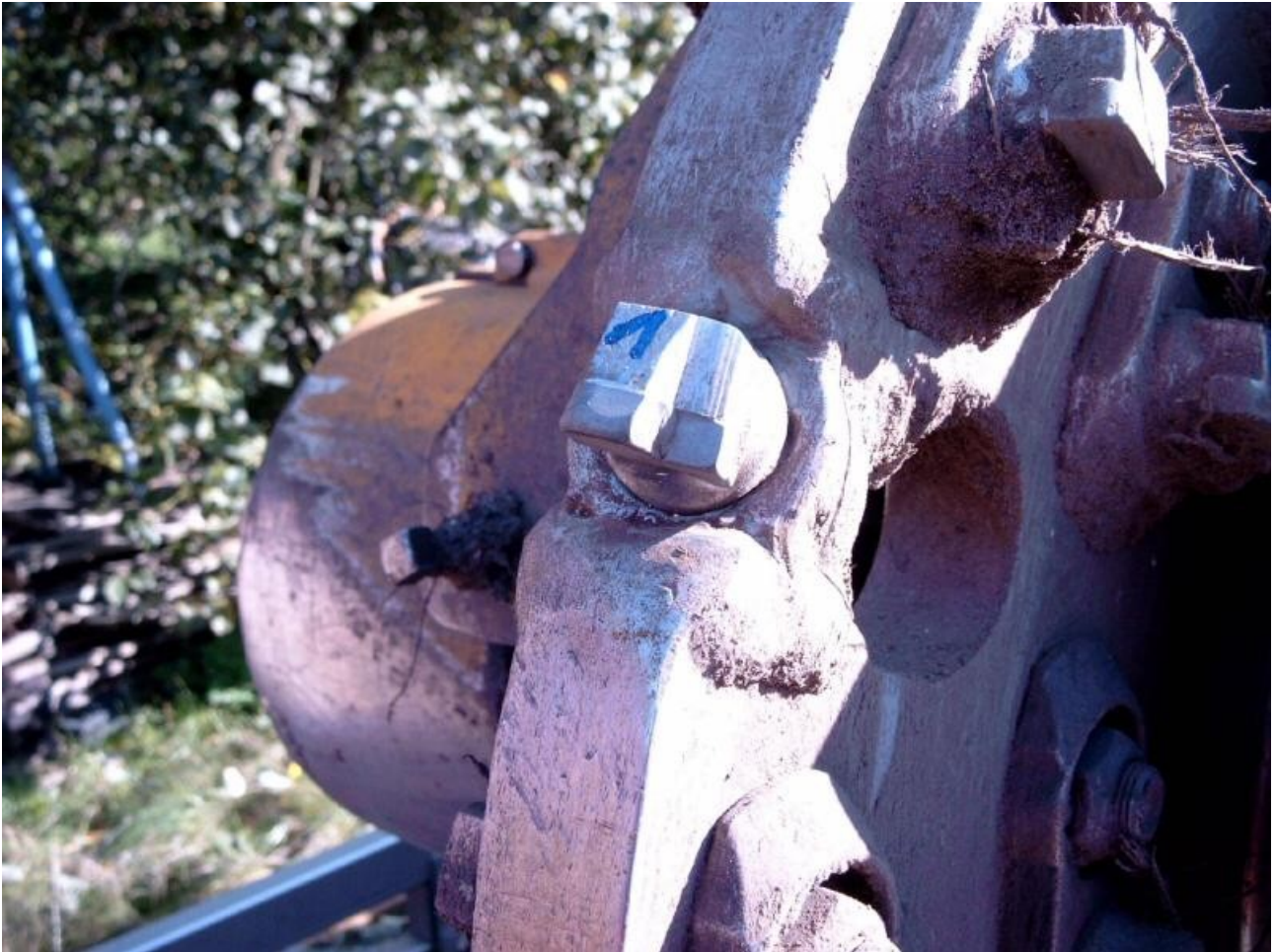
Hier sieht man an einem unteren kurzen Meißel die abgeplatzte Hartmetallplatte und danach den sofortigen Abrieb des Stahls bis auf Höhe der alten Hartmetallreste.
