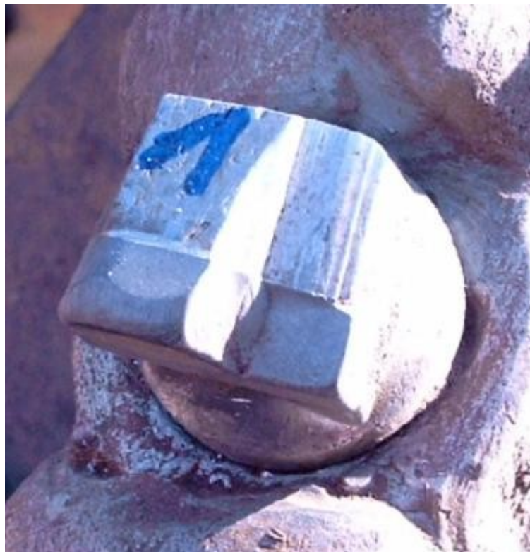
Hier sieht man an einem unteren kurzen Meißel die abgeplatzte Hartmetallplatte und danach den sofortigen Abrieb des Stahls bis auf Höhe der alten Hartmetallreste.
