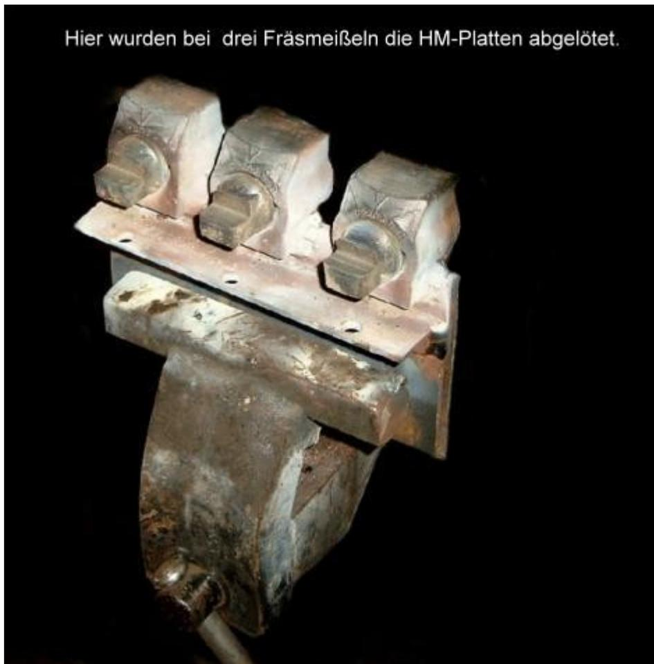
Die Hartmetallplatten werden genau wie die Fräsmeißel auf eine Metallplatte zum abkühlen gelegt. **Die Fräsmeißel dürfen niemals in Wasser abgekühlt werden!**
