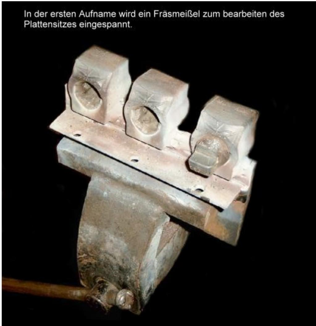
Sollten Fräsmeißel beschädigt sein,so können diese durch auftragen einer Schweißnaht wieder hergestellt werden.
