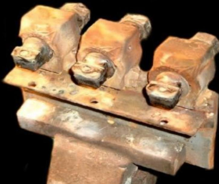
Nun werden die Fräsmeißel abgeschraubt und auf eine Metallplatte zum abkühlen gelegt. Die Muttern die Ausgleichsrohre und die Lötvorrichtung werden in Wasser abgekühlt und das Löten kann weiter gehen. So hat der Fräsunternehmer seine Leerzeit sinnvoll genutzt und über seinen Jahresabschluß wird er sich besonders freuen. Wieso ? Höherer Gewinn !
