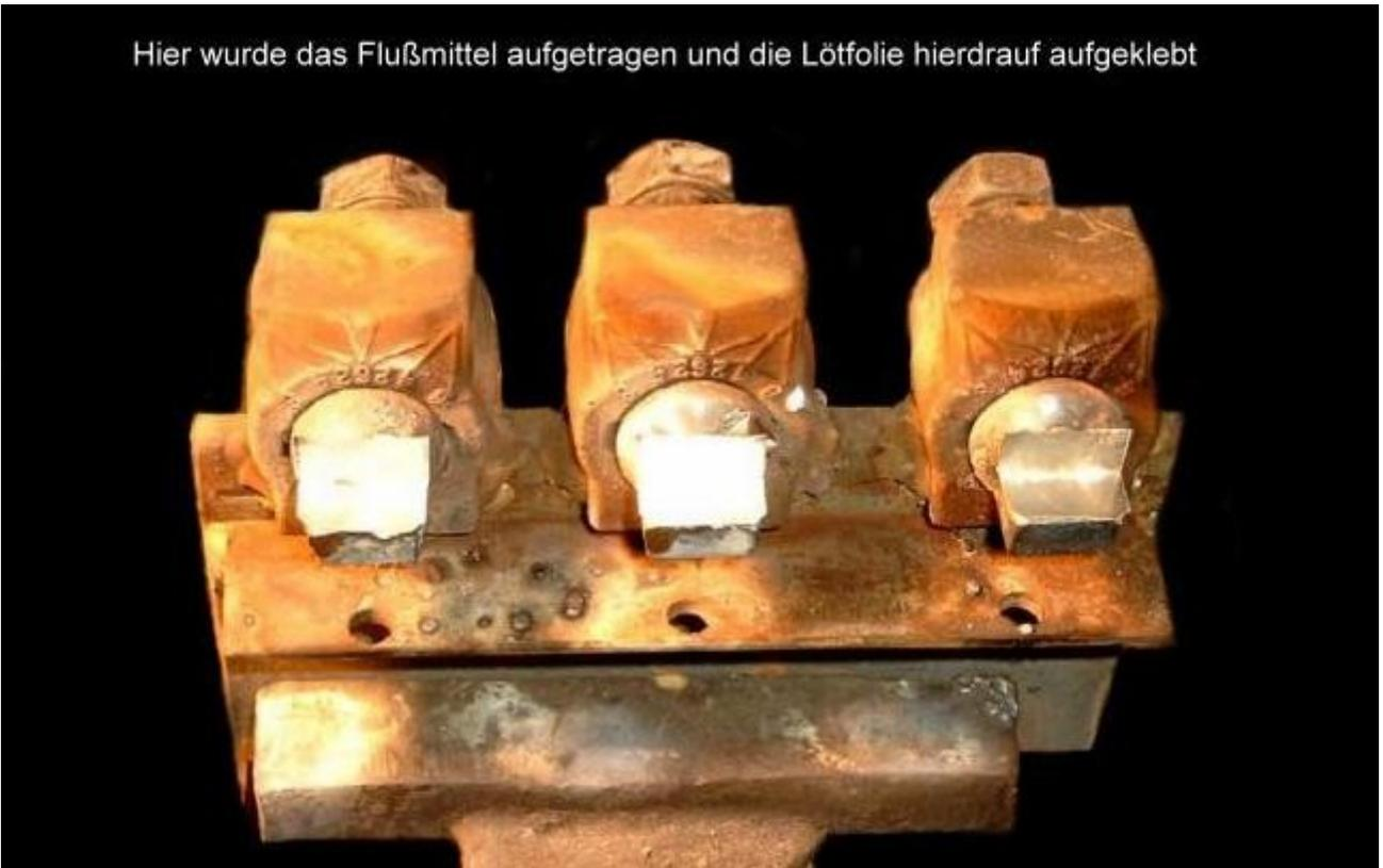
Wenn die Plattensitze sauber sind werden drei Fräsmeißel in die Lötvorrichtung eingespannt. Der Plattensitz wird mit Flußmittel bestrichen, unten und hinten. In das Flußmittel werden die beiden Stücke Lötfolie gedrückt und ausgerichtet.
